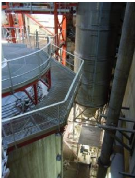
De gauche à droite : l'une des huit centrifugeuses, le local du four d'incinération et le départ vers le séparateur de particules
