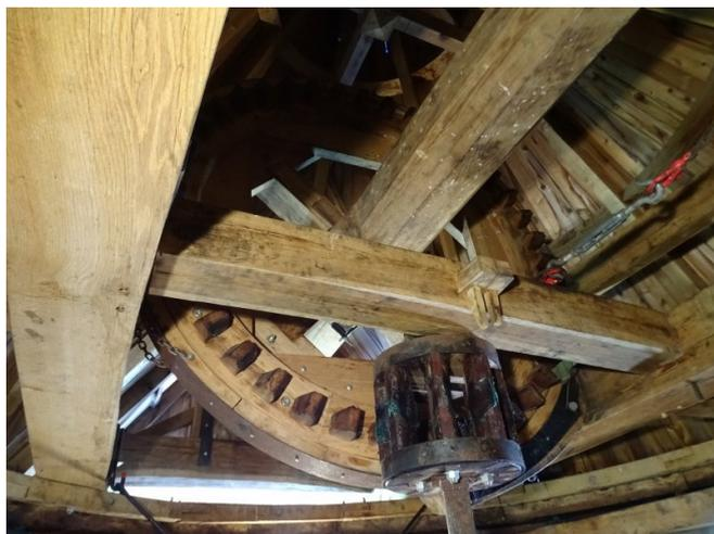
*Mécanisme d'entraînement de la meule tournante*
